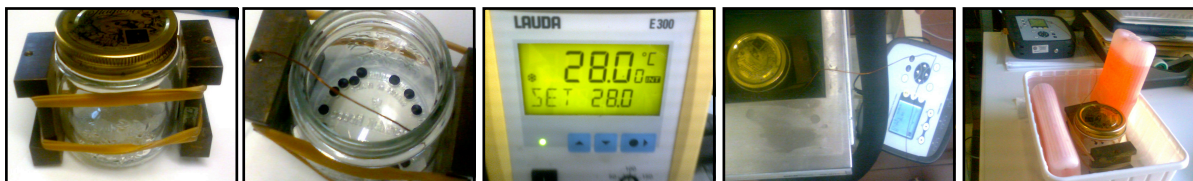
Figura 6. In ordine da sinistra a destra: vaso in vetro appesantito; campioni e termocoppia nel vaso; T di controllo e di set del bagno termico; vaso nel bagno termico e termocoppia di controllo, vaso in acqua fredda post-trattamento
