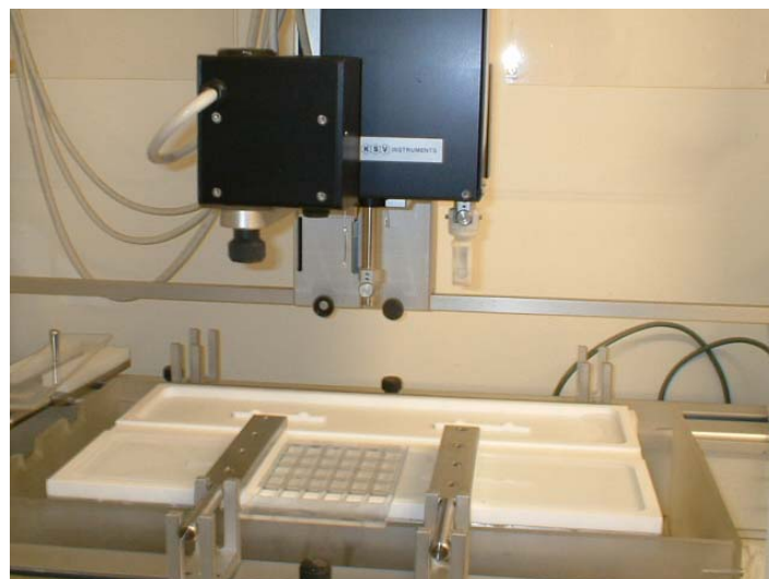
Figura 2.6 Vaschetta in teflon con barriere mobili e bilancia di Wilhelmy
