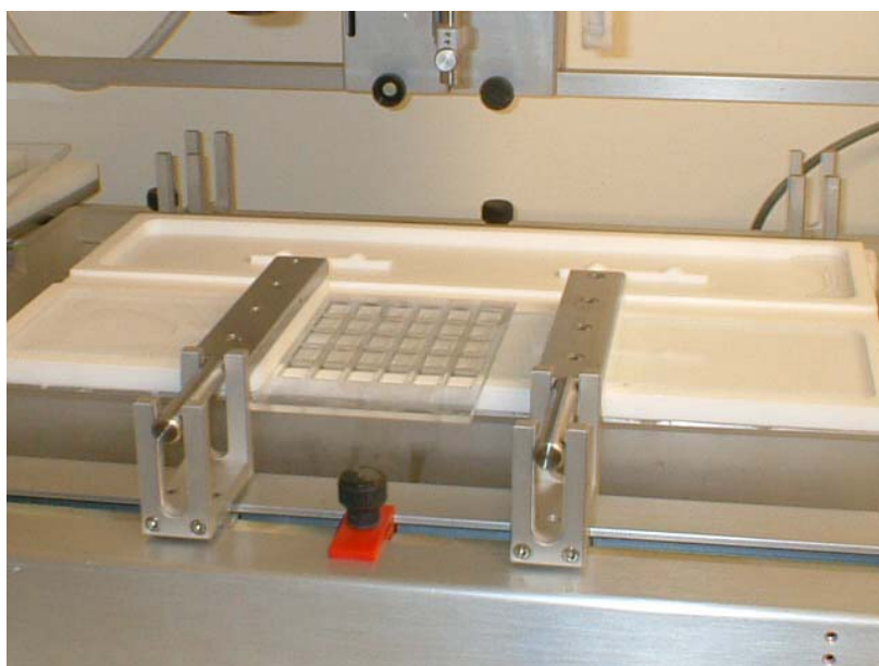
Figura 2.9 Griglia e posizione barriere impostate per la deposizione
