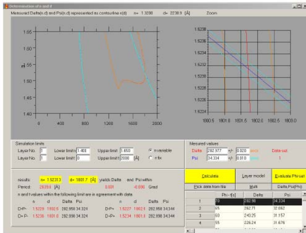
Figura 1.6 Esempio di inversione dati. Nella finestra sotto il grafico a sinistra, vengono inseriti i limiti su spessore ed indice di rifrazione. Nella finestra sotto al grafico a destra, vengono inseriti \Delta e \Psi sperimentali con i loro errori. Nel grafico a sinistra in rosso, ci sono tutti i valori di n e t , nel range fissato, a cui corrisponde lo stesso valore di \Delta , ottenuto sperimentalmente; ed in blu tutti valori di n e t , nel range fissato, a cui corrisponde lo stesso valore di \Psi , ottenuto sperimentalmente. Nel grafico a destra c'è l'intersezione tra le due linee: una ottenuta da \Delta ed una da \Psi del grafico a sinistra. Possiamo notare che a destra sono rappresentati anche gli intervalli di errore, quindi i valori ottenuti da \Psi \pm \delta\Psi e per \Delta \pm \delta\Delta . L'intersezione tra le linee è il valore cercato e viene riportato nella finestra in basso a sinistra come "results", viene anche indicato il periodo di periodicità della soluzione "period" e i limiti su n e t , dati dalle barre di errore su \Delta e \Psi .
